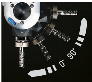
Ángulo del husillo fácilmente ajustable de 0° a 90°.
